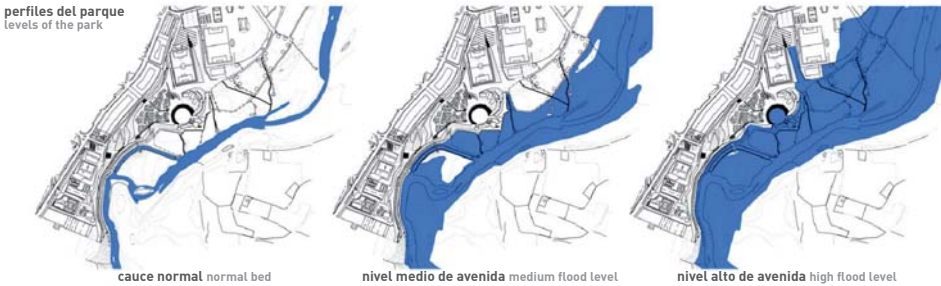
perfiles de las avenidas en estado inicial y final profiles of water rises in initial and final phases riberas del río gállego en zuera banks of the gallego river in zuera
